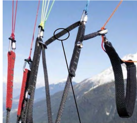
Sistema Speedbrake. Foto www.nova.eu
