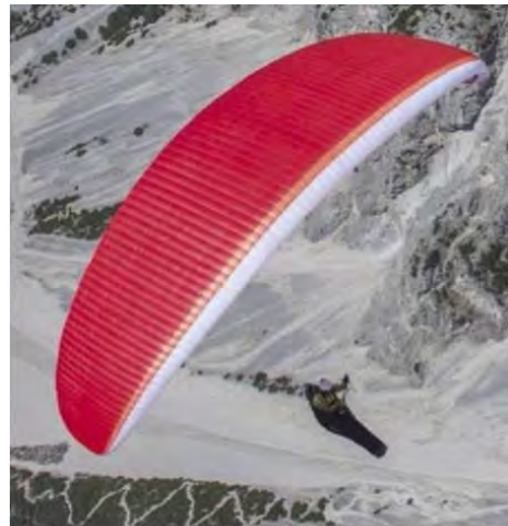
Phantom 2. Firma Nova. 3000 piezas, 99 cajones. 804 costillas ojo de aguja Alto rendimiento
