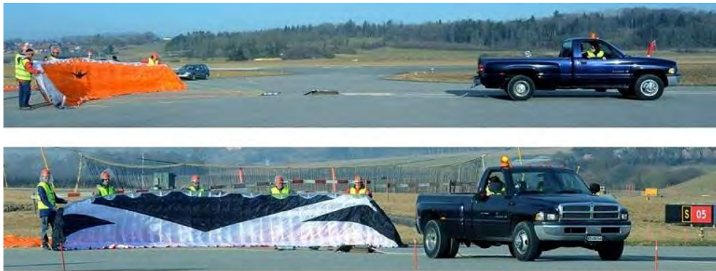
Prueba de carga. Resistencia estática. Foto Air Turquoise SA.
