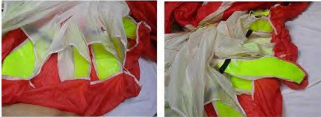
En color verde se destaca placa de Mylar cosida en las costillas para reforzar la parte del borde de ataque.
